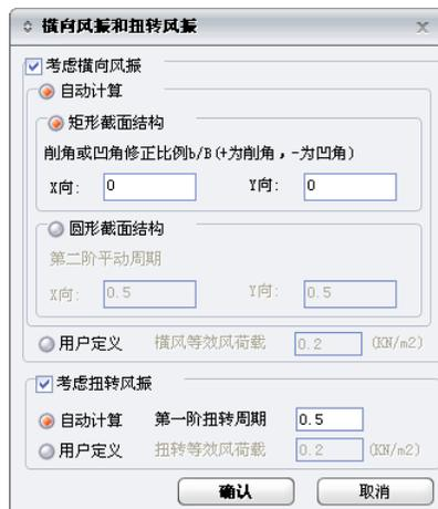
图 6.1.1-4 横风向风振和扭转风振
