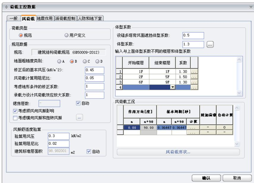
图 6.1.1-2 荷载主控数据（风荷载）
