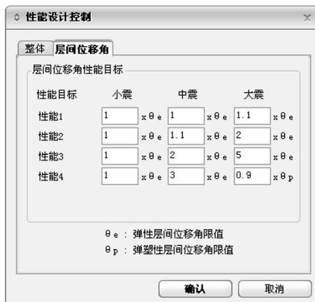
图 8.1.1-2 层间位移角控制信息（抗规）
