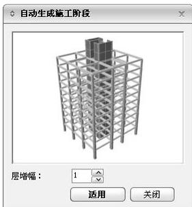
图 7.1.1-3 自动生成施工阶段数据
