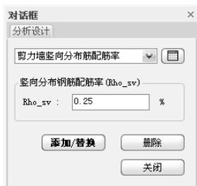
图 7.3.13 指定剪力墙竖向分布钢筋配筋率
