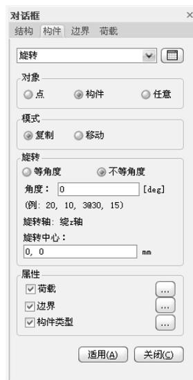
图 4.4.4-2 不等角度旋转复制构件
