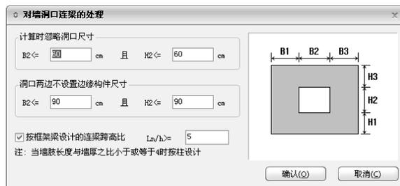
图 3.3.1-4 剪力墙洞口处理方法设置
