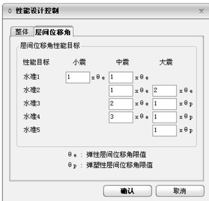
图 8.1.1-4 层间位移角控制信息（高规）
