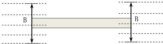
图 10.3-3 墙两侧楼板板宽度取值示意
