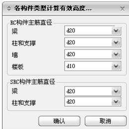
图 7.1.4-2 各构件计算截面有效高度用主筋直径
