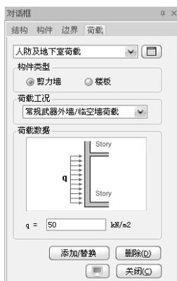
图 7.5.2-3 常规武器外墙/临空墙荷载
